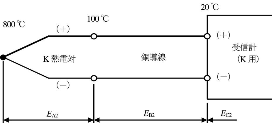
$E_{B2}$  は銅-銅（同じ金属）のため熱起電力は発生せず 0 μV である。
