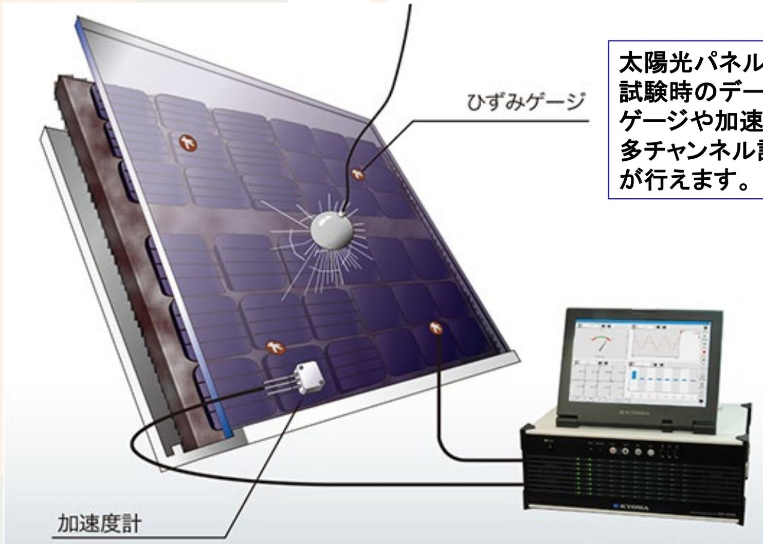
太陽光パネルの衝撃・破壊試験時のデータをひずみゲージや加速度計で検出。多チャンネル計測器で解析が行えます。
