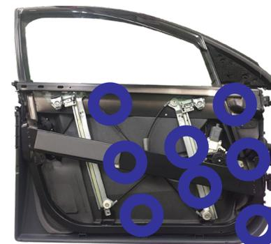
サイドミラーやドアの隙間に取付け異音計測
