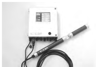
多項目水質測定システム spectro lyser （スペクトルライザ）
